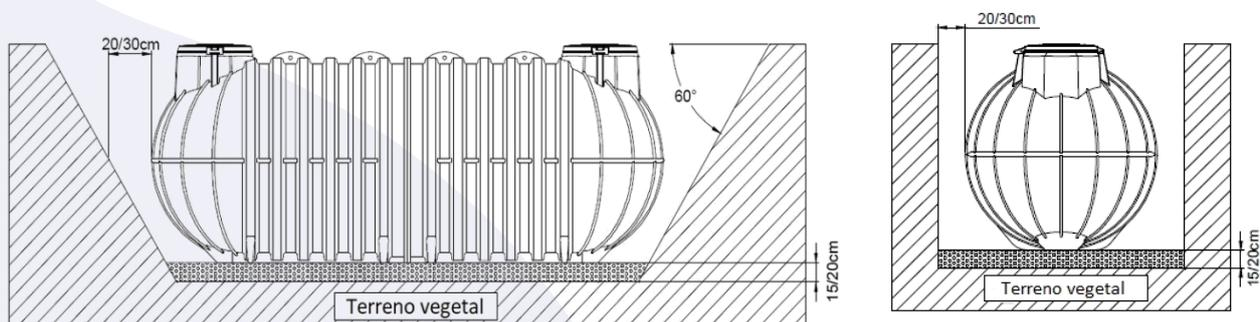
*Ilustración I: Equipo GEDAR en la excavación.*
