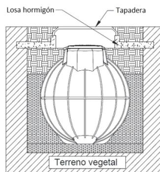
Ilustración VI: Colocación de pozos de registro con losa de hormigón.
