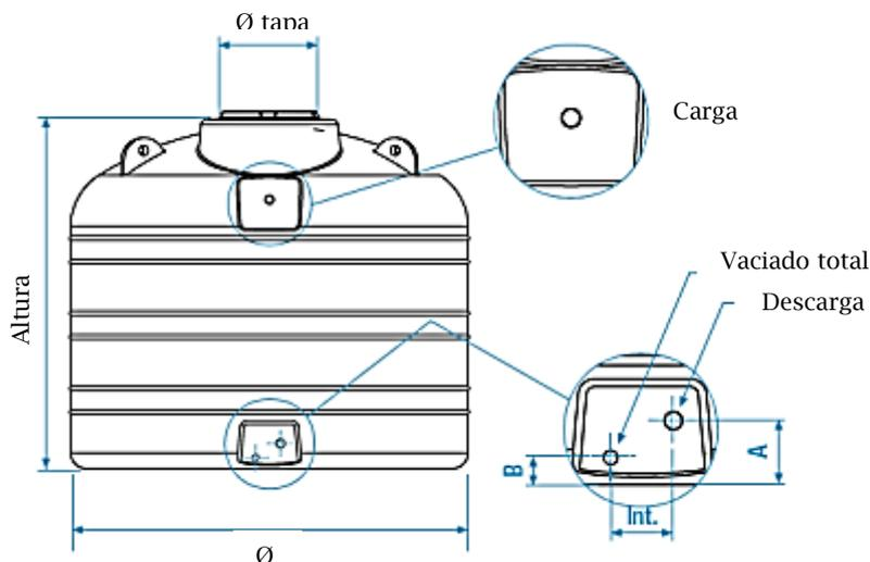
**Material:** Depósito de enterrar estanco monobloque de Polietileno de Alta Densidad (PEAD); dotado de tapón de inspección roscado con venteo y orificios de descarga y vaciado completo. **Amplia variedad de modelos.**
