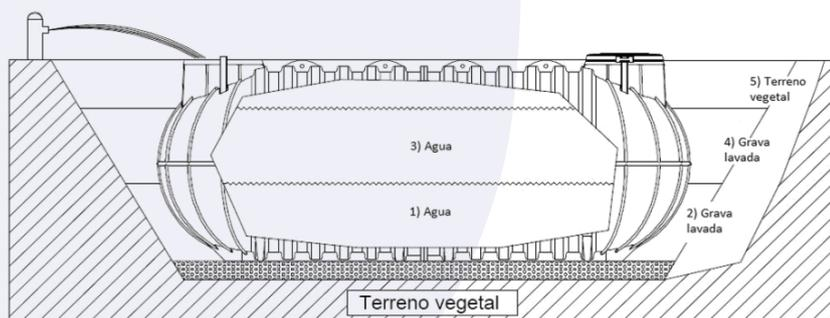
Coloque el equipo completamente vacío en la cama de grava distribuida en el fondo de la excavación, rellene gradualmente el equipo con agua y simultáneamente rellene de grava perimetral, proceder por capas sucesivas hasta 15-20cm antes de continuar para llenar el equipo debe reafirmar la grava. Llene el equipo a 3/4 de la capacidad y cubrir los últimos 40cm con tierra vegetal (el material excavado NO). NUNCA utilice material que tiene bordes afilados para evitar una fuerte presión en el tanque.
