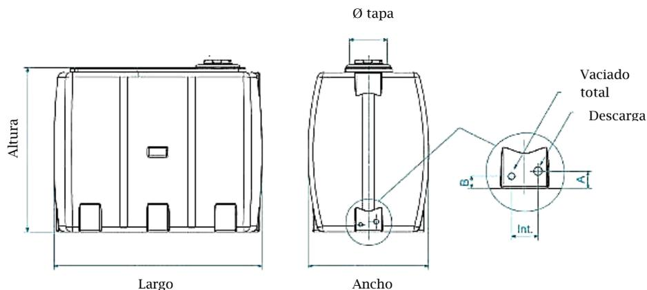
Ilustración I: Depósito exterior GEDAR modelo maleta
