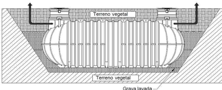
Ilustración V: Esquema de ventilación adecuada para el equipo.
