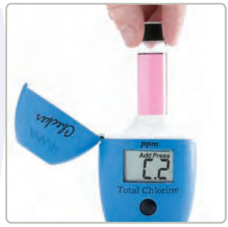
Introducir el vial en el Checker.
