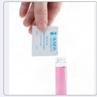
Añadir el reactivo, en polvo o líquido a la muestra de agua.
