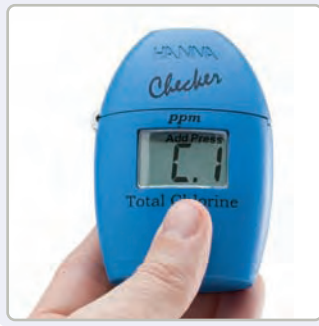
Poner a cero el Checker con su muestra de agua.
