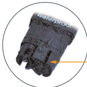
La sonda de conductividad de Grafito permite una mayor precisión porque no se ensucia con los depósitos de sales de la solución.
