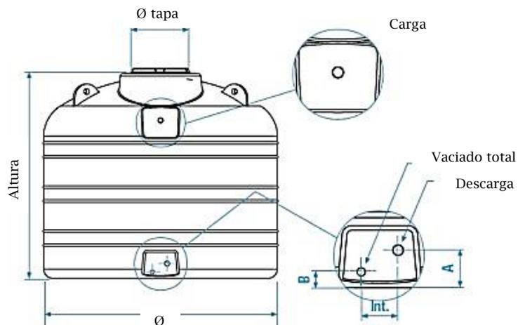
**Material:** Depósito exterior monobloque de Polietileno de Alta Densidad (**PEAD**); dotado de tapón de inspección roscado con venteo y orificios de descarga y de vaciado completo. Gracias a la instalación de juntas embridadas en PE, es posible unir más de un depósito para obtener mayor capacidad de almacenamiento. Disponibilidad de modelos soterrados. **Amplia variedad de modelos.**
