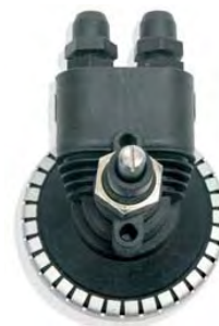
7) Pompa a depressione - Serie VP Questa pompa funziona utilizzando la pressione di risciacquo della macchina. Ad ogni risciacquo inietta una quantità di brillante regolabile da 0 a 4cc.
