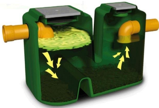
Figura 1. Separador de hidrocarburos de doble flector.
